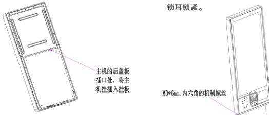
第三步：从底部插线孔，用2颗M3\*6mm，内六角的机制螺丝，将挂板锁耳与后盖板锁耳锁紧。
